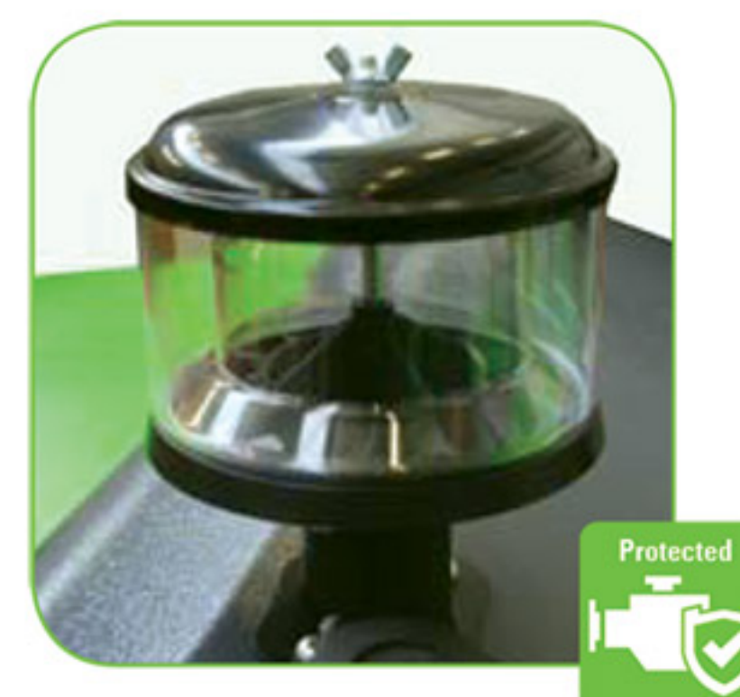
مجهز به فیلتر ساخت کمپانی دونالدسون آمریکا جهت فیلترینگ هوای ورودی موتور و جلوگیری از ورود گرد و غبار به داخل موتور
