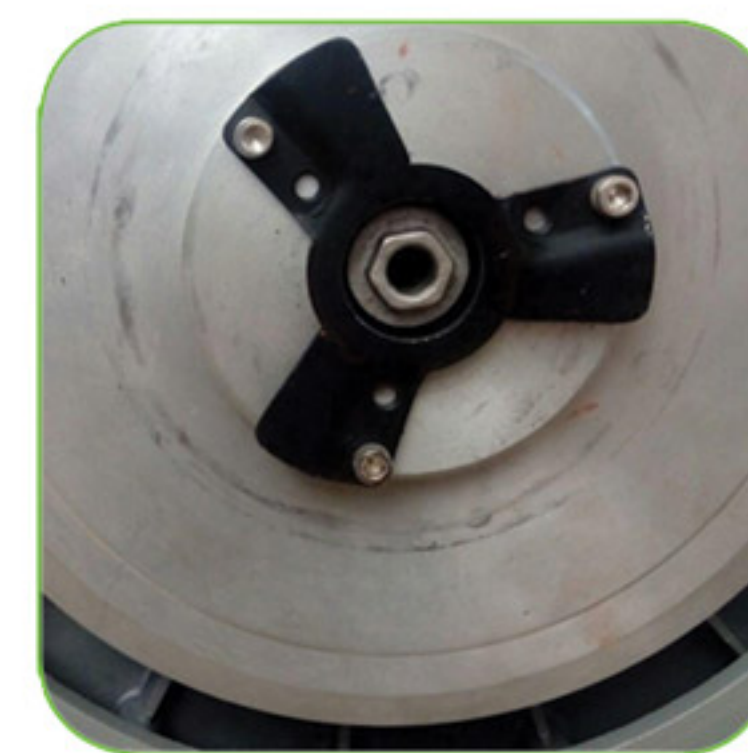
دارای سه نظام فولادی جهت قفل شدن برس و جلوگیری از در آمدن به هنگام استفاده
